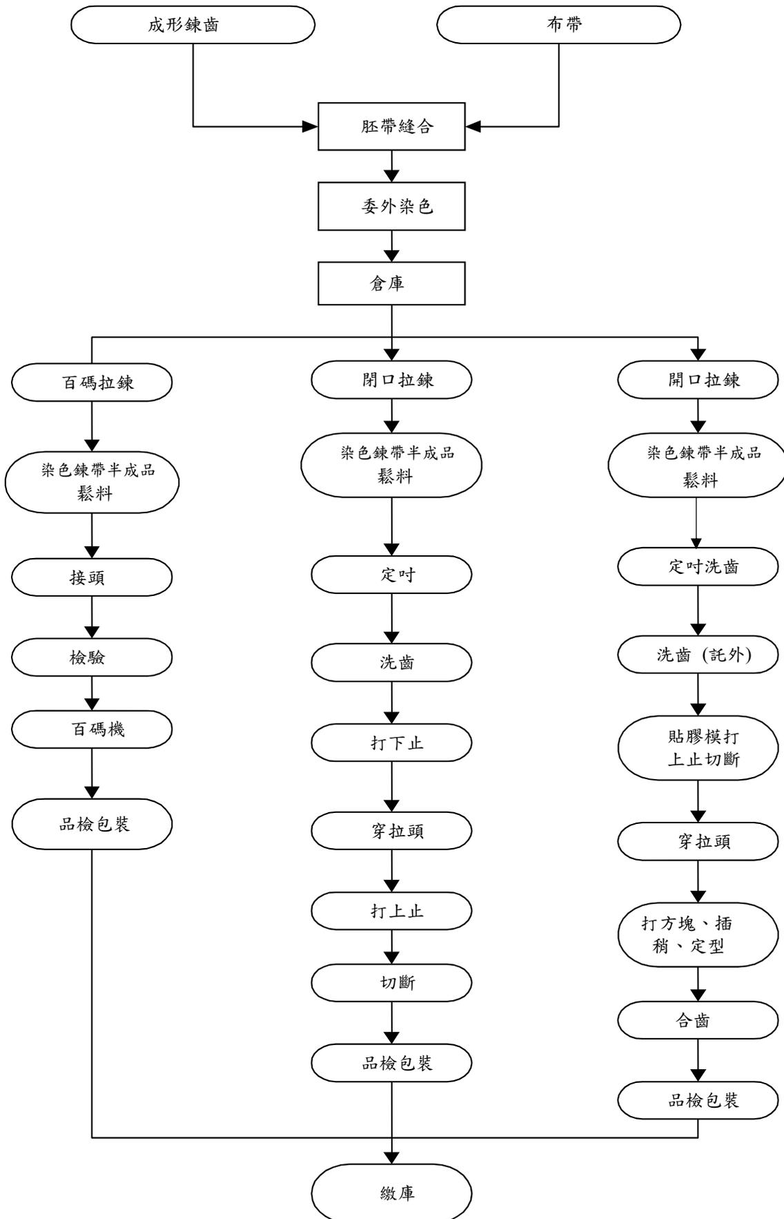
(2) 塑鋼製造流程
